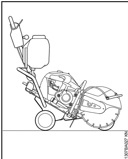
Абразивно-отрезное устройство может монтироваться на направляющей тележке STIHL FW 20 (специальные принадлежности) всего лишь в несколько приемов.
