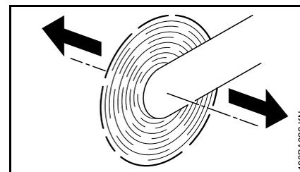
Если абразивно-отрезное устройство при вращающемся абразивно-отрезном круге перемещается в направлении, указанном стрелкой, то возникает сила, которая пытается опрокинуть агрегат.
