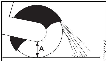
Образ действия зависит от наружного диаметра трубы и максимально возможной глубины резания абразивно-отрезного круга (А).
