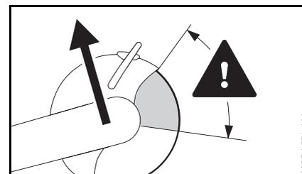
При обратной отдаче (Kickback) абразивно-отрезное устройство неожиданно отбрасывается в сторону пользователя, выходя из-под контроля.
